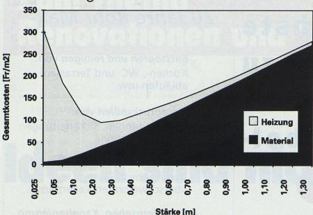
Die Grafik veranschaulicht die Gesamtkosten bei Steinwolldämmung in Abhängigkeit von der Dämmstärke (ohne allfällige Konstruktionsmehrkosten).
