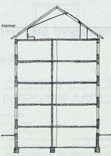
Querschnitt durch einen gewöhnlichen Mietblock mit in den Dachstock hineinmodelliertem Raum, durch ein Bettsofa möbliert und mit seitlichen zu Stauzwecken ausgebauten Resträumen
