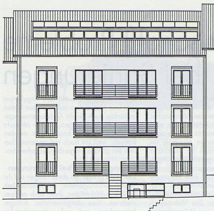
Skizze der Südwestfassade mit den Kollektorflächen am Dach. Die Mehraufwendungen sind nach sieben Jahren amortisiert – bei einer Lebenserwartung von 15 Jahren.
