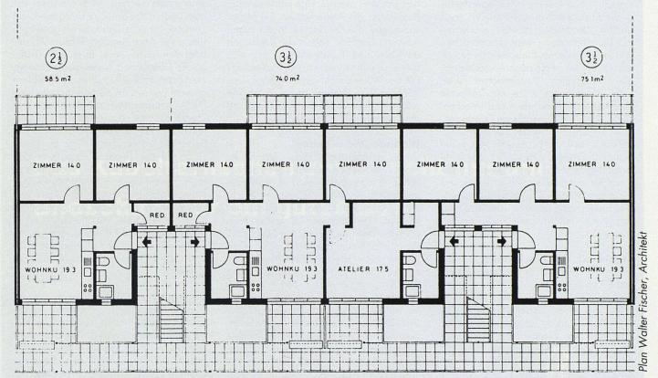
Wohnungsgrundriss: Die Zimmer sind alle gleich gross und in einer Flucht aufgereiht. So können sie auf einfache Weise zu einer Grundeinheit mit Bad, Küche und Abstellraum zusammengefasst werden. Die Nutzung ist durch die Architektur nicht fix vorgegeben: Spätere Anpassungen des Grundrisses an sich wandelnde Bedürfnisse sind möglich.
