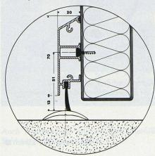
Die Halterung des Sockels kann dank Befestigungsknöpfen, ohne Bohrlöcher im Profil, montiert werden.
