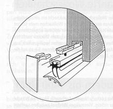
Dank den seitlich angebrachten Dichtungsflügeln vermindert sich die Luftdurchlässigkeit gemäss EMPA-Attest um 93 Prozent. Auch die erreichten Schalldämmwerte sind ausgezeichnet.
