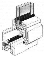
*Wärmedämmung:* bei 2-Scheiben-Verglasung  $k_F = 2,6 \text{ W/m}^2 \times \text{K}$ , bei 3-Scheiben-Verglasung  $k_F = 2,0 \text{ W/m}^2 \times \text{K}$ , bei Wärmeschutzglas  $k_F = 1,5 \text{ W/m}^2 \times \text{K}$ .
