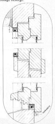
Saniertes Fenster mit Doppelverglasung. Sanierungsprofil HEBGO Nr. 121, Hohlkammerdichtung Nr. 52b
