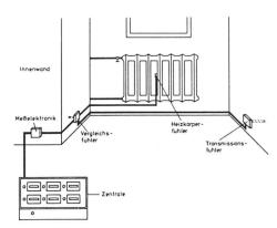
Heizkostenverteiler, elektronisches System mit zentraler Ablesung
