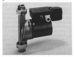
Dank der stufenlosen, elektronischen Regelung kann die Pumpenleistung optimal auf die örtlichen Gegebenheiten abgestimmt werden. Zudem läuft der Motor immer mit dem höchsten Drehmoment an, so dass nach dem Einschalten der Pumpe die Warmwasserzirkulation sofort wieder gewährleistet wird. Der stopfbuchsenlose Nassläufermotor der BW 400 zeichnet sich weiter durch geräuschlosen Lauf und geringe Leistungsaufnahme aus.
