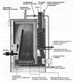
Schnitt durch den «Condensagaz»-Kessel
