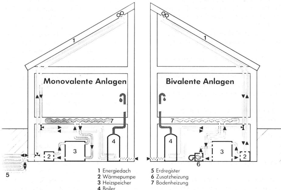
meübergang von der Außenluft auf das Energiedach, wodurch der Wirkungsgrad des Energiedach-Wärmepumpen-Systems verbessert wird.
