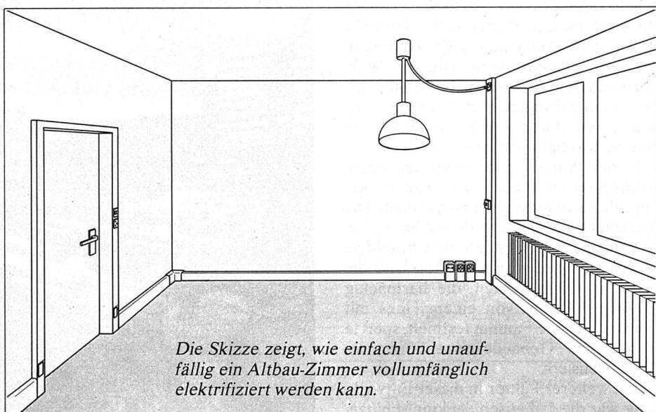
Die Skizze zeigt, wie einfach und unauffällig ein Altbau-Zimmer vollumfänglich elektrifiziert werden kann.
