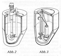
Steuerung: Der automatische Betrieb erfolgt in Abhängigkeit des Wasserspiegels im Schacht. Bei hohem Niveau löst eine Sonde oder ein Wasserstandsregler den Einschaltbefehl aus. Bei abgepumptem Niveau erfolgt durch gleiche Elemente der Ausschaltbefehl. Ebenso kann die Anlage überwacht werden, so dass bei zu hohem Wasserniveau ein Alarm ausgelöst wird, was besagt, dass die Pumpe nicht rechtzeitig eingeschaltet hat.
