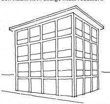
Die hier angedeuteten prinzipiellen Möglichkeiten der Fassadengestaltung können je für sich konsquent am ganzen Bauwerk angewendet oder in zweckmässiger Kombination zum Ausdruck gebracht werden. So zeigt etwa das folgende Beispiel, wie eine geschlossene Mauerfläche in Verbindung mit einer Fensterwand eine weitere Ausdrucksform des «Baukörpers» schafft. Die ungleiche Behandlung der Schmal- und Breitseite kann das Gebäude nach bestimmten Richtungen hin betonen.
