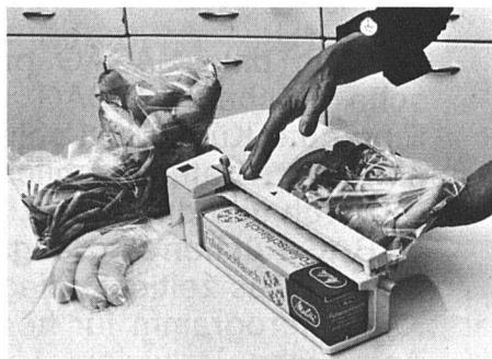
*Hauptanwendungsgebiet des neuen Melitta-Folienschweissgerätes ist die Verpackung von Tiefkühlgut in Polyäthylen-Folien, -Beutel und -Schläuche. Findige Verwender brauchen es aber auch zum Einschweissen von Textilien, zum Schutz gegen Motten, für das Herstellen von Schallplattenhüllen, von Schwimmreifen, Buchhüllen, Luftkissen oder Drachen.*
