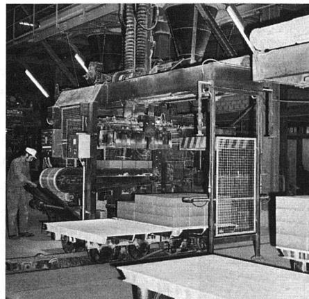
*Oben: Auf solchen automatischen Drehtisch-Steinpressen erhält der Kalksandstein seine endgültige Form. Selbsttätige Stapelgeräte stellen die Steinrohlinge auf Rollwagen, die in die Härtekessel gefahren werden.*
