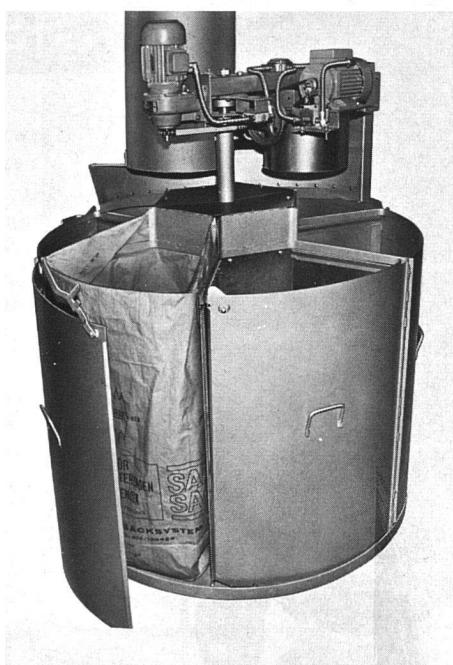
Der Hausmüll wird verpackt in ein Müllschachtröhr geworfen. Im Keller des Gebäudes fällt er in einen Gross-Papiersack. Der Müll-Komprimator verdichtet automatisch den Müll im Sack. Ist dieser voll, dreht sich das Karussell, und ein leerer Sack ist wieder bereit.
