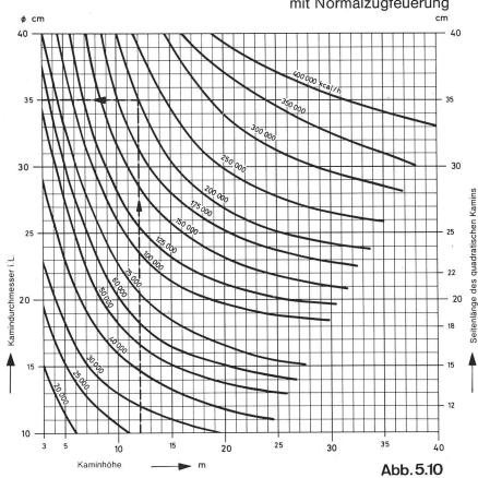
Die Kaminquerschnitte sind gültig für flüssige und gasförmige Brennstoffe unter folgenden Bedingungen:
