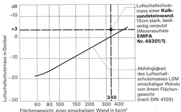
Dieses Diagramm zeigt die Abhängigkeit des Luftschatzmassen LSM einschaliger Wände von ihrem Flächengewicht (nach DIN 4109); je schwerer die Wand, um so besser die Schalldämpfung. Im Schnittpunkt der gestrichelten Koordinaten — über der Kurve — liegt der Messwert für eine Kalksandsteinwand (15 Zentimeter stark, beidseitig verputzt).
