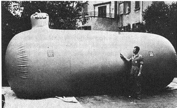
derte öl- und wasserbeständige Folie wird in den leergepumpten Heizöltank eingebaut. Zwischen der Kunststoffhaut und der Innenseite des Heizöltanks sorgt ein Zusatzgerät für ein Vakuum, so dass sich die Blase eng an die Tankinnenwand anschmiegt. Sobald sich im Heizölbehälter eine undichte Stelle bildet, löst ein Warngerät ein optisches und akustisches Signal aus. Diese Einrichtung wird von den Behörden als vollwertiger Schutz anerkannt.
