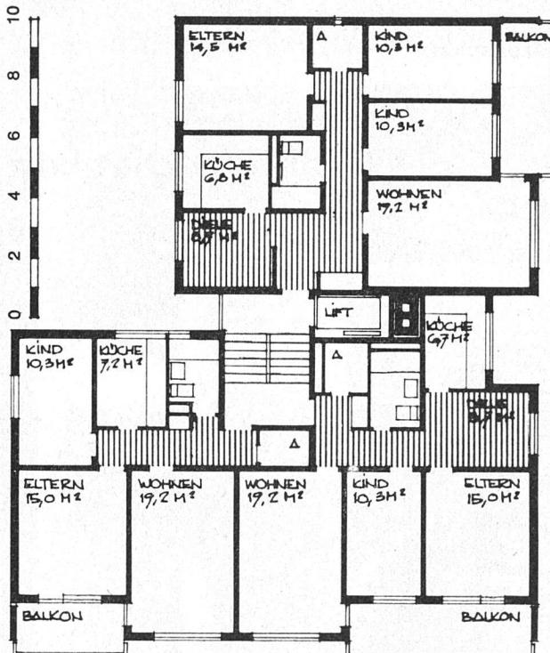
nen, Massivdecken konventionell an Ort und Stelle erstellt, Treppenläufe, Stürze, Fenster- und Balkonbrüstungen vorfabriziert und versetzt. Auf das Umfassungsmauerwerk werden innen eine 3 cm starke Sageplatte aufgezogen und eine 4 cm starke tapezierfertige Seccopanplatte vorgemauert. Die Fenster werden in einer Holz-Metall-Konstruktion ausgeführt und mit geräuscharmen Leichtmetallrolladen versehen.
