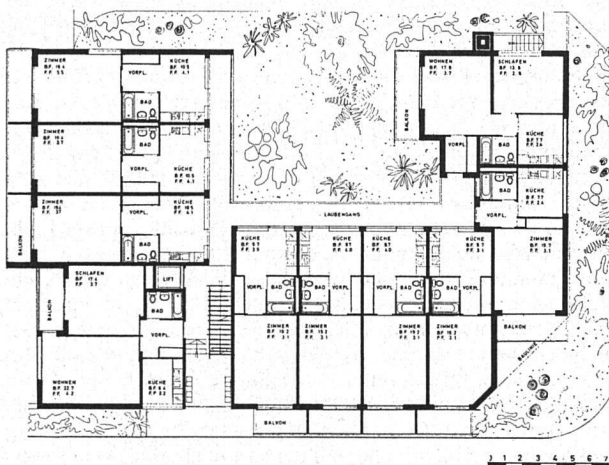
Wohnungen für Betagte in Zürich 9. Erdgeschossgrundriss. Bauherrschaft: Baugenossenschaft «Sonnengarten», Zürich. Architekten: A. F. Sauter & A. Dirlir, dipl. Architekten SIA, Zürich. Dreigeschossiger, U-förmiger Laubengangtyp mit insgesamt 30 Wohnungen: 24 Einzimmer- und 6 Zweizimmerwohnungen.
