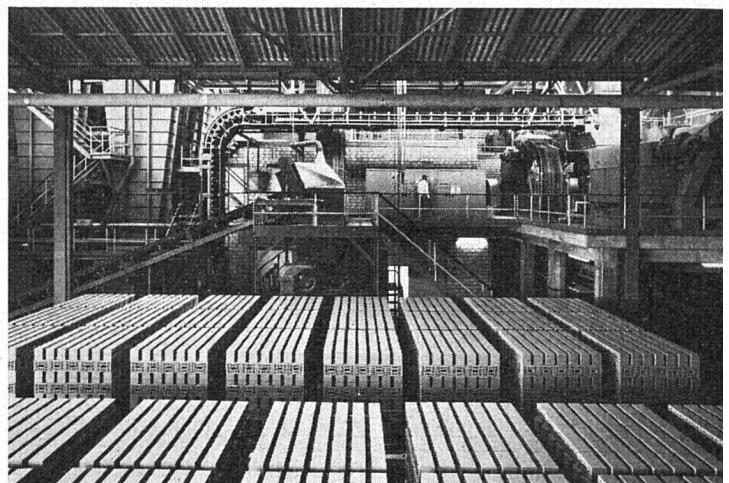
Kürzlich wurde in Tuggen SZ eine Produktionsstätte für Backsteine in Betrieb genommen, die sich von den landläufigen Betrieben erheblich unterscheidet. Kennzeichnend für dieses modernste Backsteinwerk weit und breit ist der hochmechanisierte und zum grossen Teil elektronisch gesteuerte Fabrikationsablauf. Es handelt sich um das jüngste Werk der Zürcher Ziegeleien, dessen Produkte dank der sozusagen vollautomatischen Fertigung qualitativ absolut auf gleichmässig hoher Stufe stehen.
