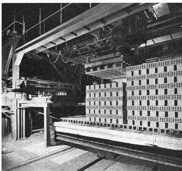
Unser Bild oben zeigt im Vordergrund beladene Tunnelofenwagen. Im Hintergrund die Aufbereitungsanlage. Von links nach rechts: Lehmzufuhr, Walzenbrecher, Steuerschrank, Walzwerke, Kollergang. Förderbänder stellen die Verbindung zwischen den Maschinen her. Das Bild zeigt deutlich die gedrängte, raumsparende Bauweise durch Verwendung senkrechter Förderer.
