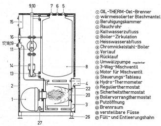
Abb. 1 Schnittbild des Minitherm-Wechselbrandheizkessels, Typ WFB.
