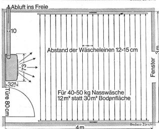
Abbildung 1. Aufriss und Grundriss eines Trockenraumes mit Bedaco-Warmluft-Wäschetrockner
