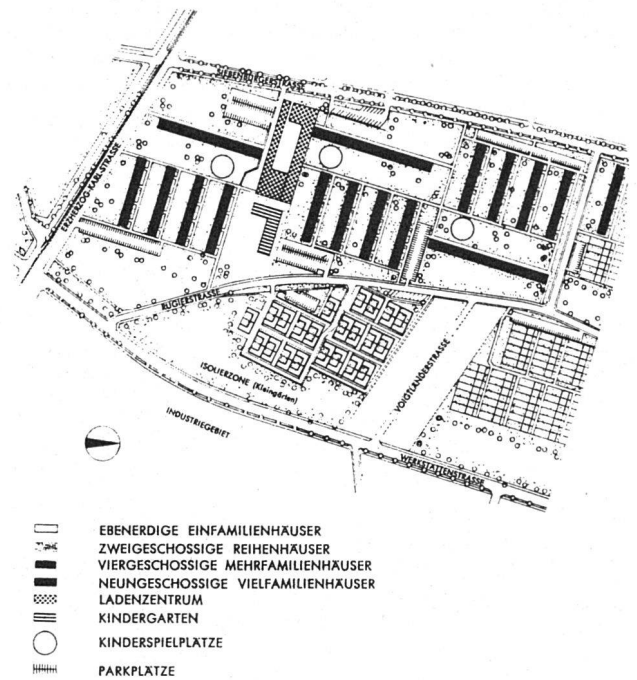
Städtebauliche Überlegungen: Darstellung eines Wohnviertels.
