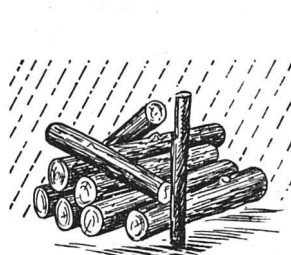
Nicht aufgespalten, ungedeckt am Boden liegend – schlechte Austrocknung, Pilz- und Käferbefall.
