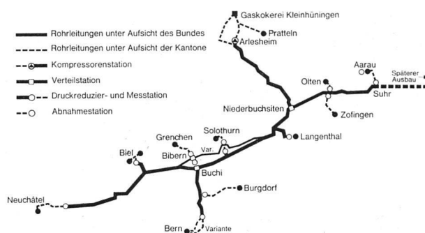
Das Trasse des vor der Ausführung stehenden Hochdruck-Transportnetzes der Gasverbund Mittelland AG mit Basel als vorläufig erster Produktionszentrale.
