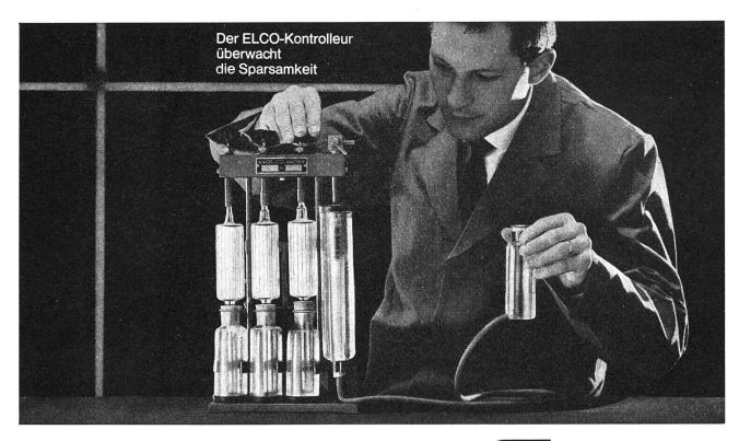
Bevor ein ELCO-Oelbrenner das Werk verlässt, wird er im Prüfstand einer exakten Schlusskontrolle unterzogen. Eine Phase daraus sehen Sie auf dem Bild! Die Rauchgas-Analyse mit dem CO<sub>2</sub>-Prüfserät. Damit wird der ELCO-Brenner auf sparsamste Verbrennung einreguliert. — ELCO-Oelfeuerungen Die Schlusskontrolle gibt Ihnen und uns Telefon 051 48 40 00
