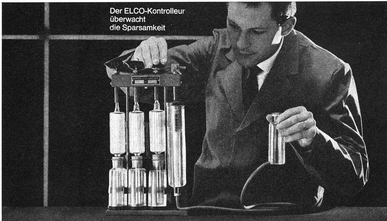
Bevor ein ELCO-Oelbrenner das Werk verlässt, wird er im Prüfstand einer exakten Schlusskontrolle unterzogen. Eine Phase daraus sehen Sie auf dem Bild! Die Rauchgas-Analyse mit dem CO2-Prüfgerät. Damit wird der ELCO-Brenner auf sparsamste Verbrennung einreguliert. — Die Schlusskontrolle gibt Ihnen und uns
