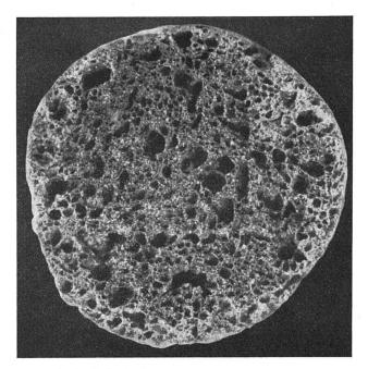
Querschnitt durch ein einzelnes Leca-Korn
