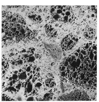
Querschnitt durch Leca-Leichtbeton
