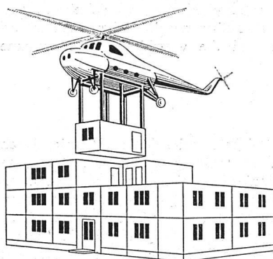
Montieren ganzer Geschosse auf ebener Erde und Anheben auf Etagenhöhe in der Sowjetunion («Kassettenmethode»)
