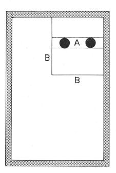
Schema eines gewöhnlichen Kühlschrankes herkömmlicher Bauart. Ein einziger Verdampfer A kühlt zugleich für Gefrierfach und Normalkühlraum. Große Wärmeübergangsflächen B bewirken Angleichung der Temperaturen in den beiden Zonen. Keine echte Tiefkühlung.
