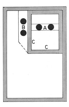
Schema eines echten Zweitemperaturenschrankes. Separater Verdampfer A zuständig ausschließlich für das Tiefkühlabteil. Getrennt arbeitender Verdampfer B kühlt den Normalkühlraum. Kompakte Isolation C des Tiefkühlabteils verhindert Temperaturausgleich und ermöglicht Temperaturunterschiede von über 20 Grad C zwischen Tiefkühlabteil und Kühlschrank.
