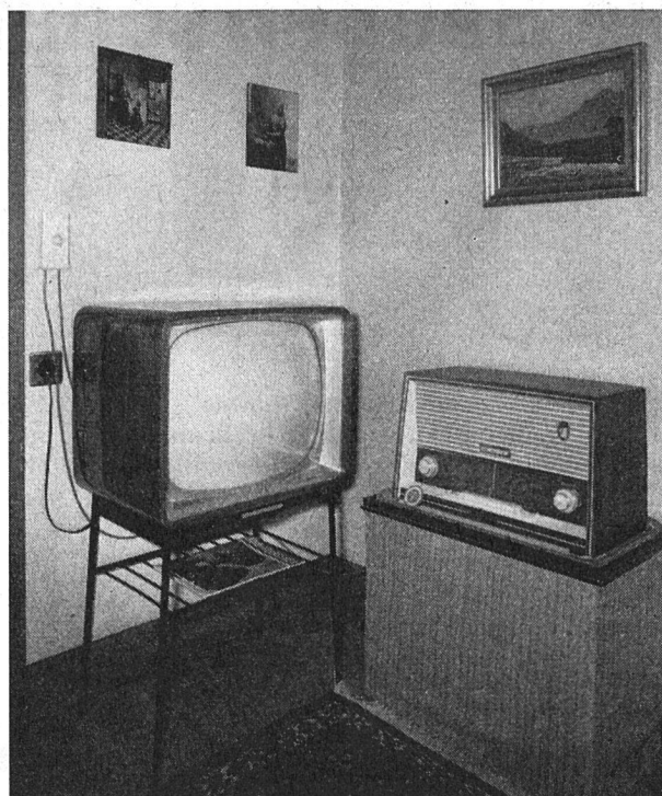
Beispiel eines kombinierten Abonnentenanschlusses für Drahtfernsehen und Hochfrequenz-Drahttrundspruch. Die Auswahl der Programme geschieht beim Drahtfernsehen durch Drehen des Schaltknopfes der Wähldose an der Wand, beim Hochfrequenz-Drahttrundspruch durch Abstimmung am Empfänger selbst.
