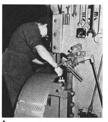
Hier entsteht einer der wichtigsten Teile der Waschmaschine: die Trommel. Die trichterför-mige Vertiefung der einzelnen Löcher sorgt für ein absolut schonendes Waschen
