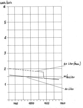
Fig. 4 Entwicklung des Energieverbrauches bei den Sibir-Kühlschränken
