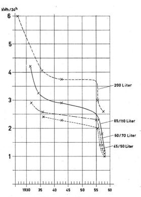
Fig. 3 Entwicklung des Energieverbrauches für verschiedene Kühlschrankgrößen (Elektrolux – Entnommen aus «Das Wohnen» 1958, Nr. 6)
