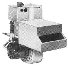
ner wird auf eine ausschwenkbare Türe montiert und ist somit gut zugänglich für Reinigung oder allfällige Revisionen. Der Motor mit zwei Tourenzahlen schaltet automatisch bei Pilot-flamme auf niedere Tourenzahl und gleicht die Luftmenge dem Ölzufluß an. Der Heizkessel kühlt sich deshalb nicht so stark ab. Der Kemac-Automatic-Ölbrenner funktioniert wartungsfrei Tag und Nacht. Die Temperaturregulierung erfolgt mittels Kesselanliegethermostats oder auf Wunsch zusätzlich mit Zimmerthermostat.
