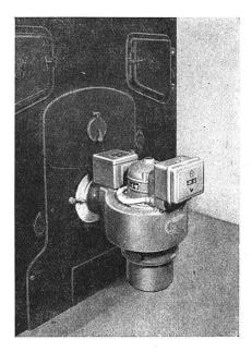
Der Typ Cuenod-Junior wird von den Besitzern kleiner Einfamilienhäuser sehr geschätzt, da er sie im Winter von allen Heizsorgen befreit. Dieser Brenner ist auf dem Prinzip der Luftdruckzerstäubung konstruiert; es ist das einzige System, das eine vollkommene Verbrennung bei kleiner Leistung gewährt. Die Leistung kann zwischen 1 und 4½ 1/Std. reguliert werden.
