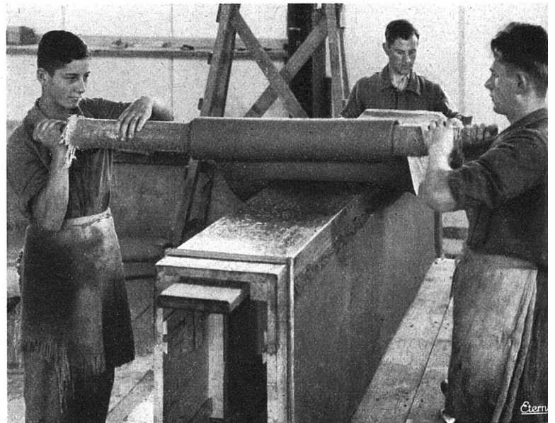
Abb. 12 Das zweite Plattenstück wird aufgelegt und angeformt
