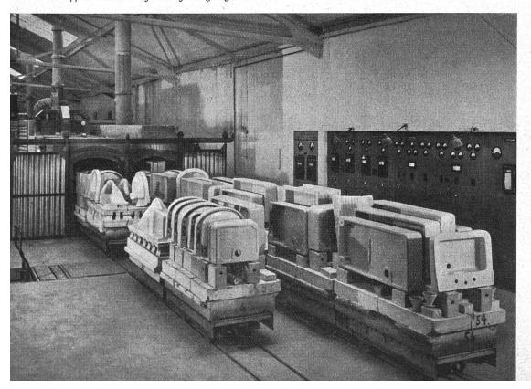
kate im Fabrikationsraum zum Vortrocknen, um dann in der Trokkenkammer richtig ausgetrocknet zu werden. Damit die Rißgefahr möglichst vermieden wird, bläst der Ventilator zuerst feuchte und dann immer wärmere und trocknere Luft in die Kammer, bis die Temperatur auf 60 Grad steigt und alles Wasser verdunstet ist.
