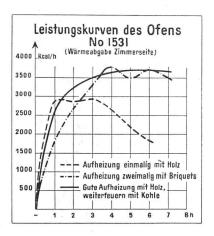
Die gestrichelte Linie zeigt, wie bei der einmaligen Beschickung durch Holz nach einer halben Stunde schon mehr als die Hälfte der überhaupt möglichen Wärmeabgabe erreicht ist.
