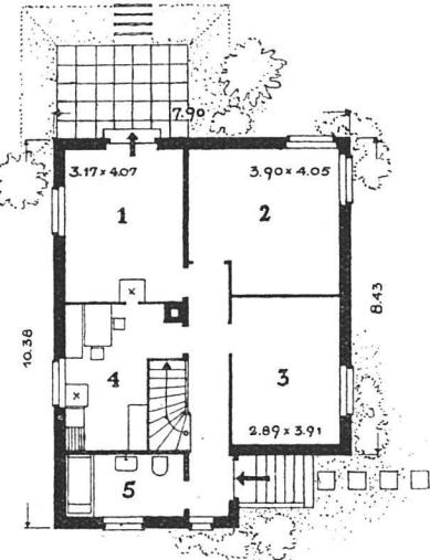
Die Kellerumfassungen wurden in Stampfbeton 30 Zentimeter stark, das aufgehende Mauerwerk in Backsteinen mit innerer Korkplattenverkleidung ausgeführt. Das Dach ist zur besseren Warmhaltung mit einem Bretterunterzug verschalt. Die Dacheindeckung besteht aus Falzziegeln. Im Wohnzimmer befindet sich ein Kachelofen, von der Küche aus heizbar; als Zusatzheizung für die übrigen Zimmer wird ein Tragofen verwendet.
