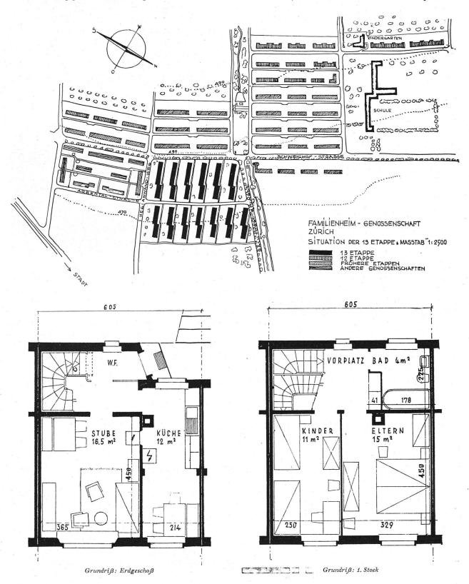
besonnung stehen die Bauten der 13. Etappe senkrecht zum Hang mit Süd-Südostlage der Zimmer. Der prächtige Blick aus dieser Gegend auf die Stadt wird jedem dem Gefälle des Baulandes sind die Reihen gestaffelt angeordnet, indem von Doppelhaus zu Doppelhaus ein Höhenunterschied von etwa einem Meter vorhanden ist. Um die Länge der Reihen zu mildern, wird in jedem Block nach dem vierten talseitigen Haus eine Verschiebung der Fassade um 2,30 m vorgenommen.
