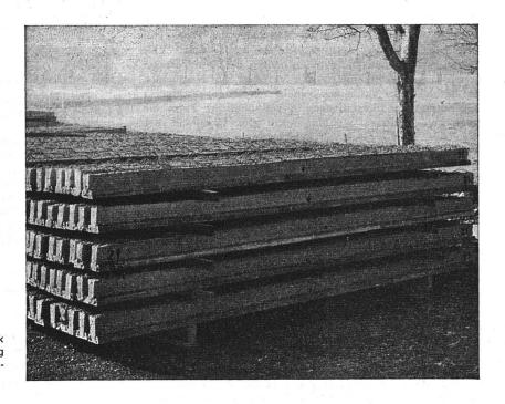
Norma-Betonbalken Die richtige Balkenlagerung in der Fabrik und auf der Baustelle: Auflager beidseitig ca. 1/s der Balkenlänge ab Balkenkopf einwärts
