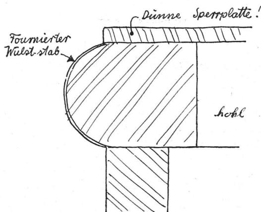
und hier eine der konstruktiv richtigen Lösungen:
