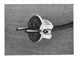
Gefährlicher beschädigter Stecker. Beim Gebrauch wird auch die spannungführende Schraube berührt.
