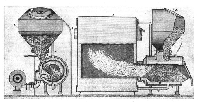
BRENNER IN VERBINDUNG MIT KESSEL. — 1. Brennersilo. 2. Brenner. 3. Heizkessel. 4. Ventilator. 5. Luftklappe. 6. Abschlußschieber. 7. Verbindung zwischen Kessel und Brenner. 8. Luftverteilungsraum. 9. Brennerzug. 10. Kühlmantel. 11. Isoliermantel.
