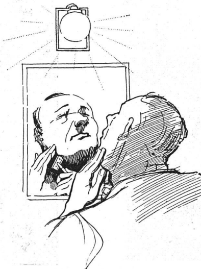
Ungenügende und falsch montierte Spiegelbeleuchtung
