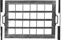
Holzfenster in Pitsch-Pin, Föhren- u. Lärchen-holz mit 3 T-Eisenspros-sen u. zwei Handgriffen mit freiem Wasseraus-lauf oder Wasserrinnen, verglast od. unverglast. In allen Größen lieferbar Normalgrösse 100/150 und 90/150.
