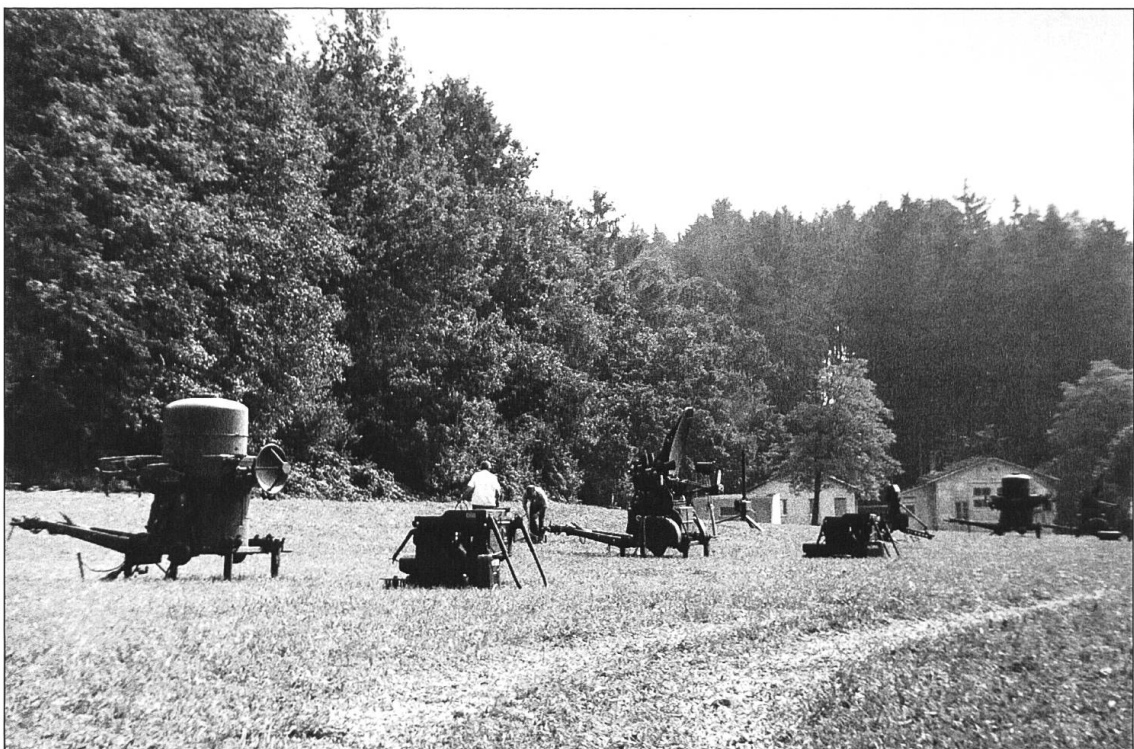
Das komplette Waffensystem (eine Feuereinheit) lässt sich von zwei Geländelastwagen Pinzgauer 6x6 transportieren. Das eine Fahrzeug zieht den Lenkwaffenwerfer, das zweite Fahrzeug den Zielfolgeradar. Ein drittes Fahrzeug führt weitere Lenkwaffen und zusätzliches Material mit sich.
