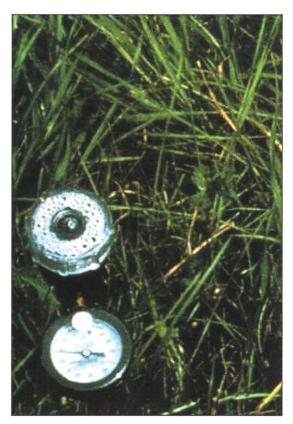
Mit solchen Tensiometern wird die Bodensaugspannung zur Beurteilung der Bodenschonung gemessen.
