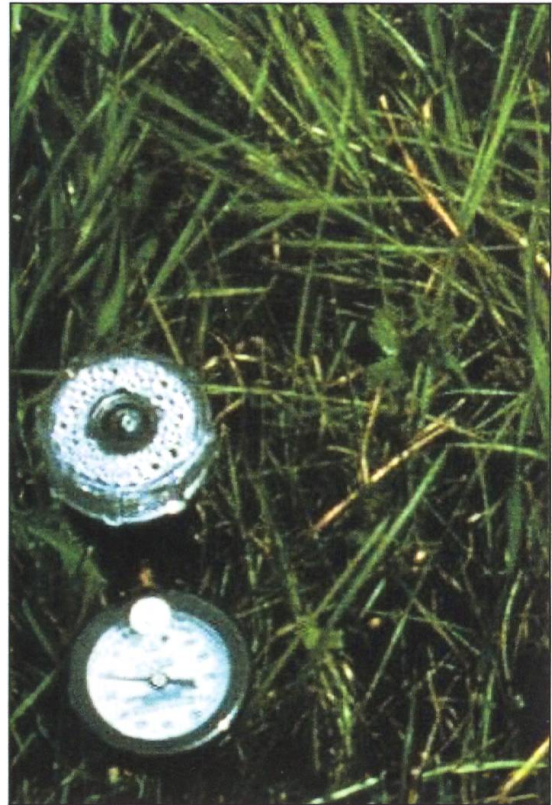
Mit solchen Tensiometern wird die Bodensaugspannung zur Beurteilung der Bodenschonung gemessen.
